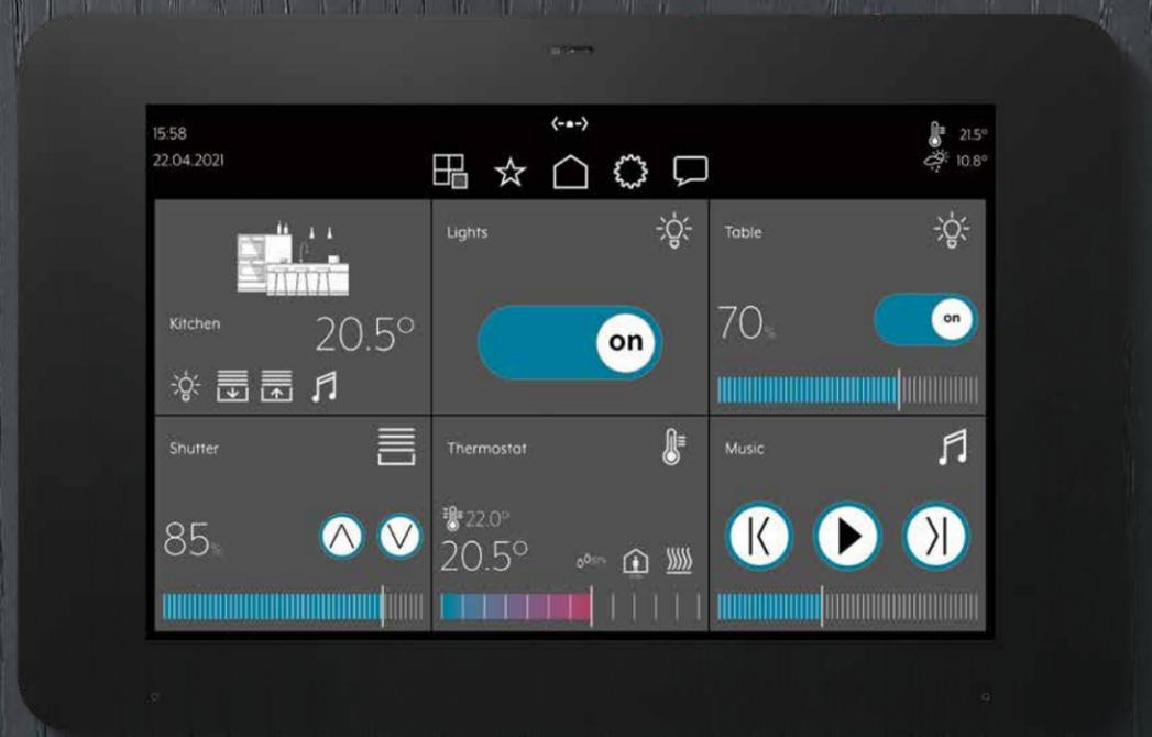
KNX Smart Panel 8 с сенсорным дисплеем от компании JUNG дополняет систему «умного дома», принося дополнительный комфорт и безопасность в инсталляцию. Она позволяет создать визуализацию вашей KNX-системы без использования дополнительного сервера. Управление может осуществляться через локальную сеть с помощью приложения, что идеально подходит для дооснащения существующих систем.
