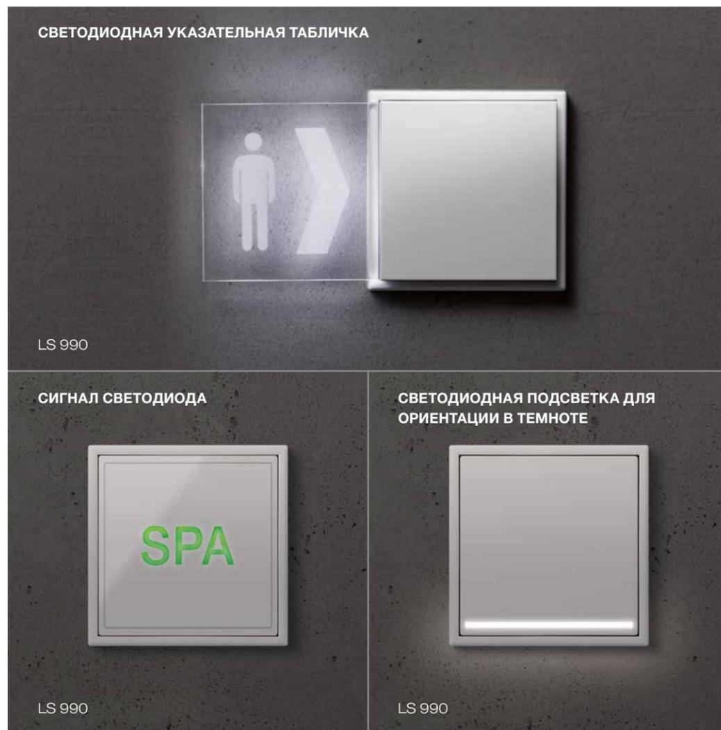
Подсветка для ориентации в темноте розетки со светодиодом не слепит и гарантирует надёжное ориентирование в условиях отсутствия освещения. Светодиод заподлицо встроен в декоративную накладку, а свет нейтрально-белого цвета излучается вниз настроенным световым конусом. Благодаря датчику освещённости он светится, только когда темно.
